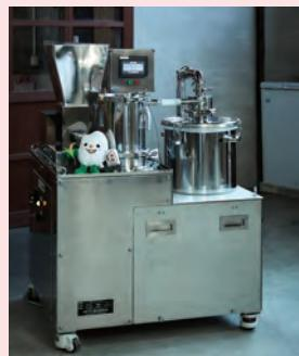
最新の湿式気流製粉機を使ってミズホチカラから米粉を作る。専用の機械のため新鮮で、きめこまかนา米粉ができる
